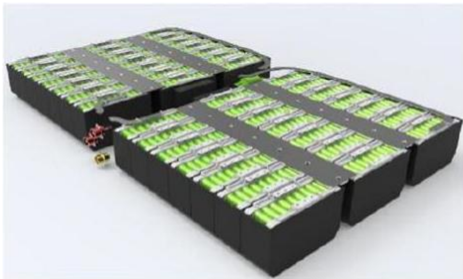
图 4.2-3 典型汽车动力锂电池包内部的模组内部结构实物图
